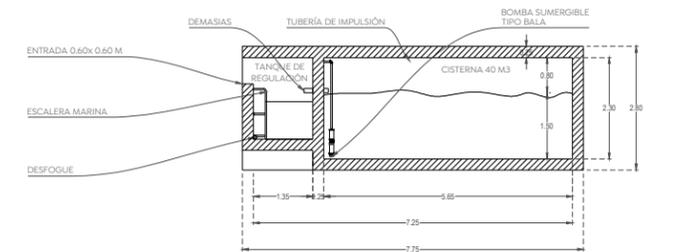
**SCALL-02 Cisterna 40m3 y tanque de retenciones (planta y sección a-a')**
