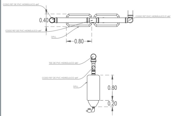
**SCALL-01 Dispositivo de primeras lluvias (DPLL-Alzado lateral y planta)**
