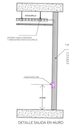
**DETALLE SALIDA EN MURO**
