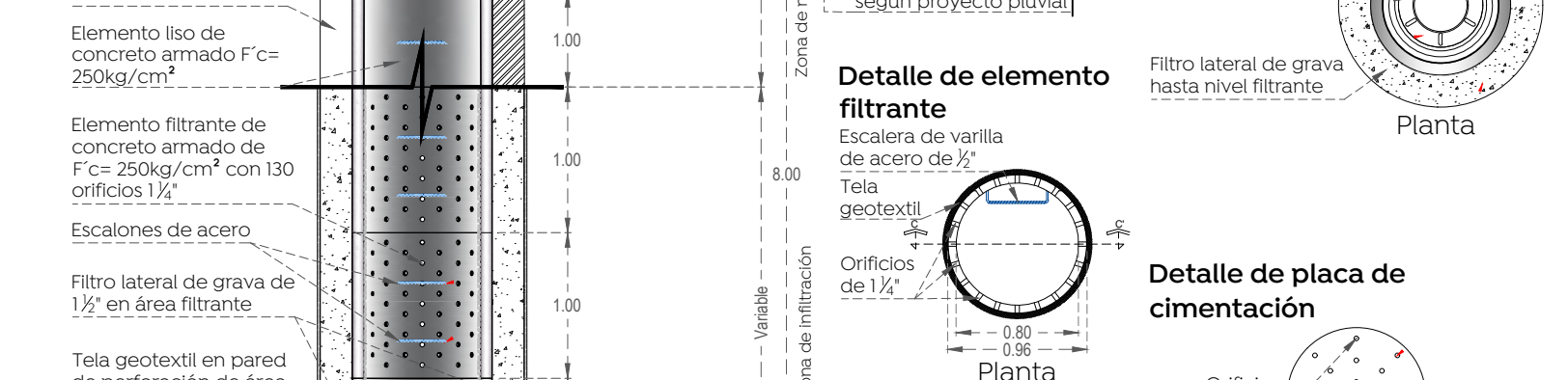
Pozo de infiltración modelo 1.40m Ø Esc. 1:50
