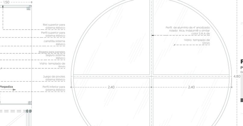
**CN-16** Claraboya fija de 4.30x4.30m a base de aluminio anodizado Mca. Indalum® o similar color S.M.A., vidrio claro de 9mm templado y película de seguridad.
