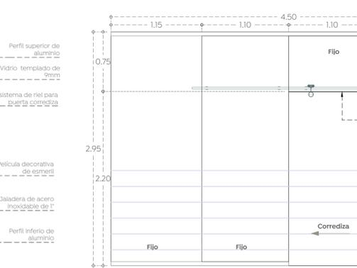
**CN-11** Cancel corredizo compuesto por dos fijo en medidas totales de 4.50 X 2.85 m a base de aluminio de 2" anodizado Mca. Indalum® o similar color S.M.A. Cristal claro de 9mm recocido más película de seguridad Modelo SRC100-4 o similar, sellado con silicón transparente. Incluye: jaladera de embutir
