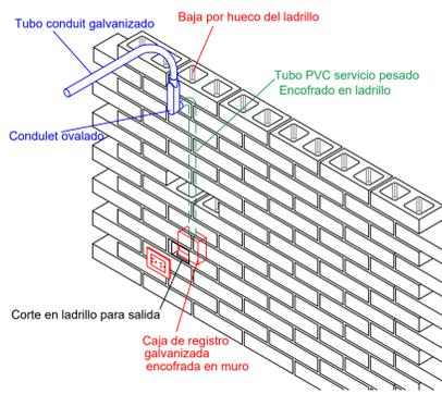
Detalle de bajada de apagador y/o contacto en muro de ladrillo
