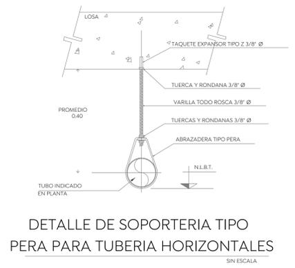
DETALLE DE SOPORTERIA TIPO PERA PARA TUBERIA HORIZONTALES SIN ESCALA
