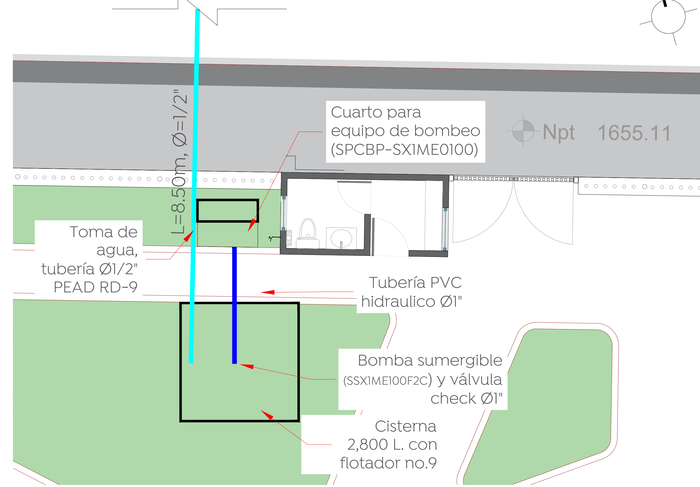
04 Detalle de cisterna APO-01
