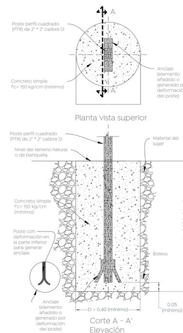
2.2 Detalle de cimentación para señales Escala 1:20
