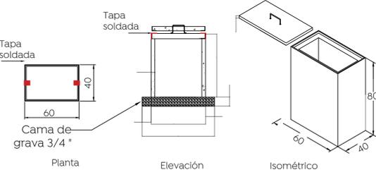
Registro precolado 40X60X80 cm, con marco y contramarco galvanizado por inmersión en caliente, fabricado con concreto hidráulico F'c= 200 Kg/cm<sup>2</sup>, registro armado con malla 6X6-10/10 en muro y malla 6X6-6/6 en tapa, muros de 4 cm de espesor con acabado cemento pulido, marco con ángulo de 1-1/2" X 1/8" y espesor de 3.18 cm. Incluye: agarradera para la tapa elaborado en acero redondo de 3/8" galvanizado por inmersión en caliente, rondanas y tuercas de 3/8" galvanizadas para su sujeción.
