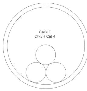
Diámetro de tubería: 51mm (2"Ø)
