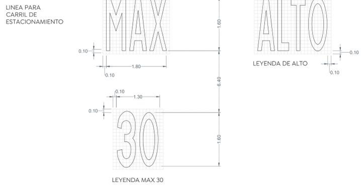
1 Detalle señalamiento horizontal Escala 1:50
