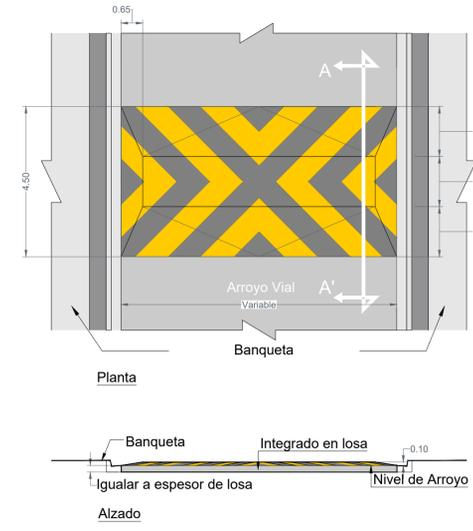
3 Detalle reductor de velocidad Escala 1:10
