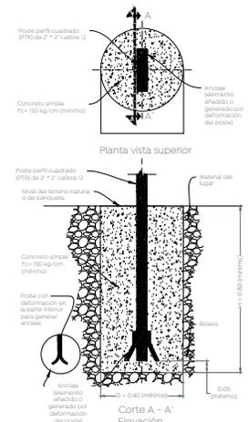
2.2 Detalle de cimentación para señales Escala 1:20
