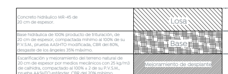
8 Conformación de pavimento Escala 1:10
