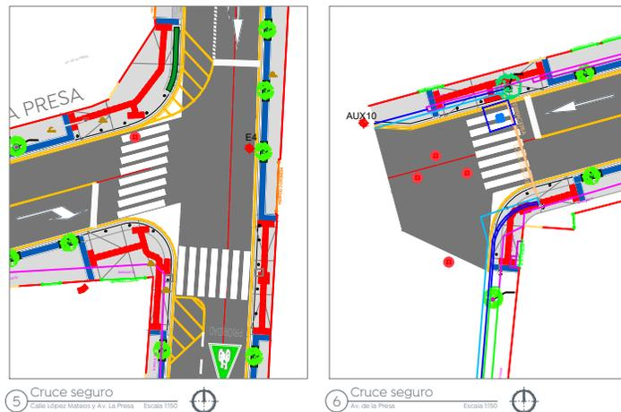
**ESPECIFICACIÓN:** Loseta vibro-prensada prefabricada con textura táctil puntual o lineal en formato 40 cm x 40 cm x 4 cm de espesor, de uso peatonal, con resistencia a la compresión  $F_c=250 \text{ kg/cm}^2$ .
