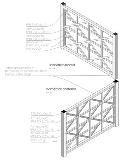
03 Detalle de armadura tipo
