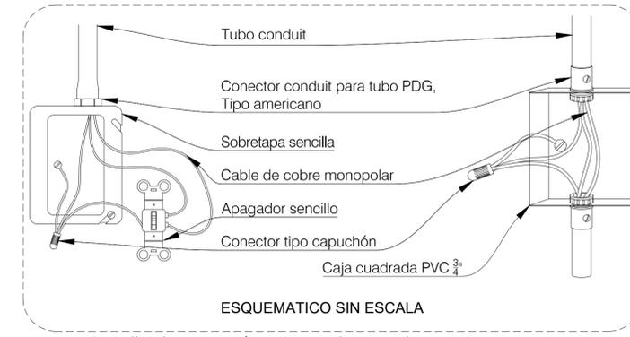
03 Detalle de conexión a tierra de caja de registro
