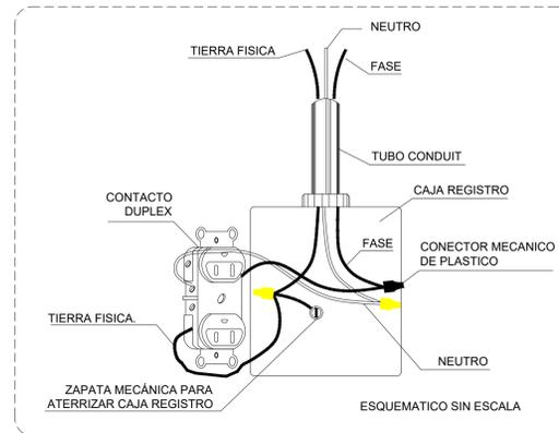
02 Detalle de conexión de contacto polarizado
