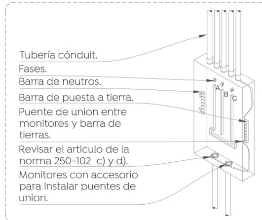
05 Detalle instalación de tablero de distribución.
