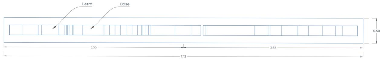
Letras de lamina galvanizada y/o acero al carbón Cal 20 o 16, acabados en primer blanco, con pintura automotriz Dupont, color y tipografía a elección del cliente (de no mayor de 1,20 de ancho). Base de lamina galvanizada y/o acero al carbón cal. 18, con estructura interna en PTR de 1 1/4"
