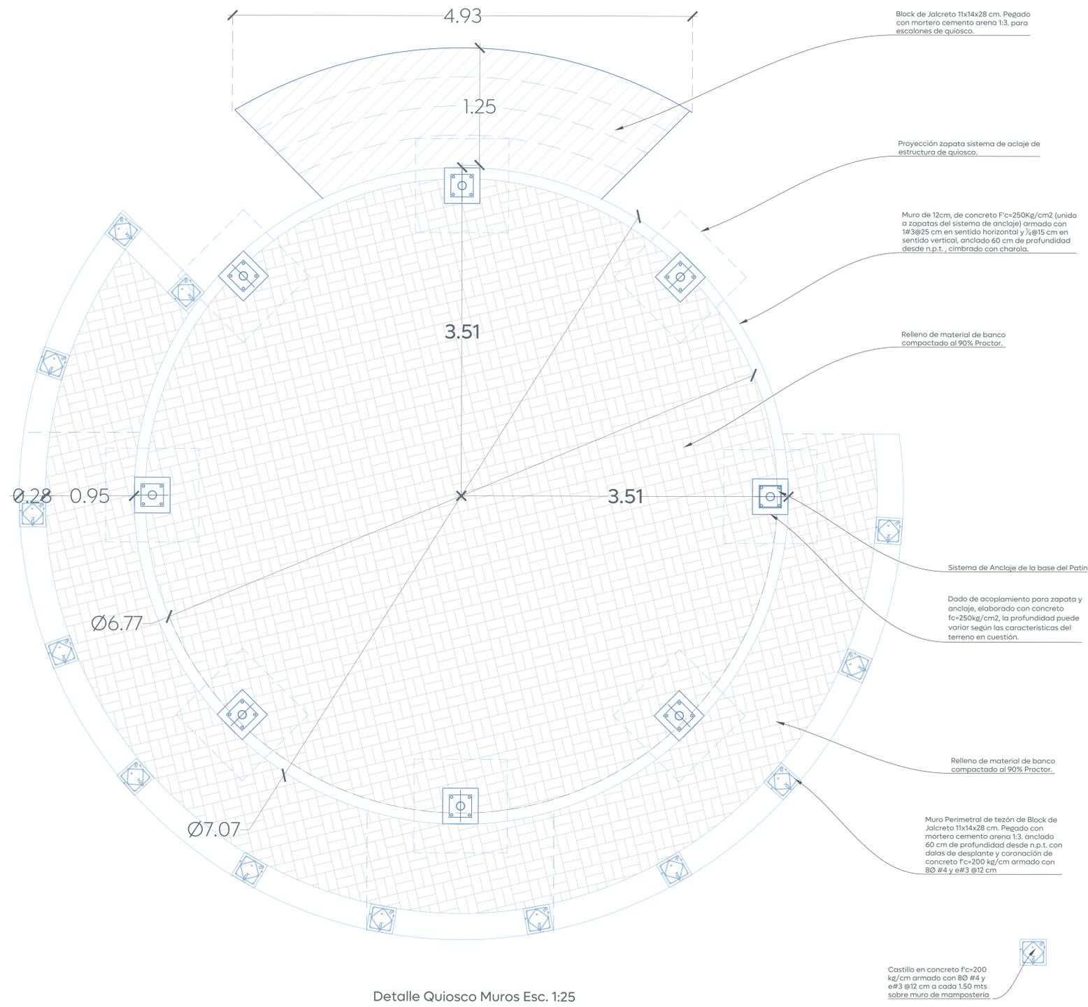
Detalle Quiosco Muros Esc. 1:25
