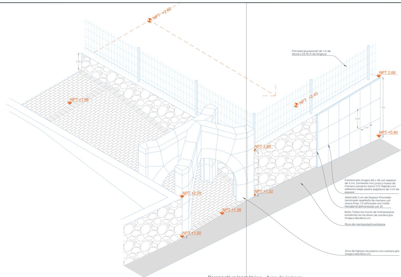
Perspectiva Isométrica - Arco de ingreso, Rampa de Ingreso y Muros existentes S/E
