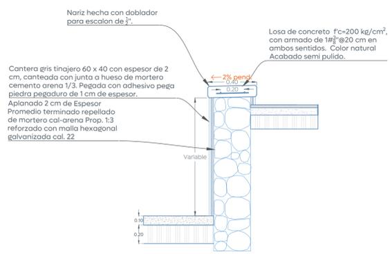
Muro de mampostería existente sección Esc. 1:25
