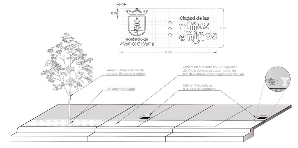
Detalle de configuración de banquetas Esc. 1:20
