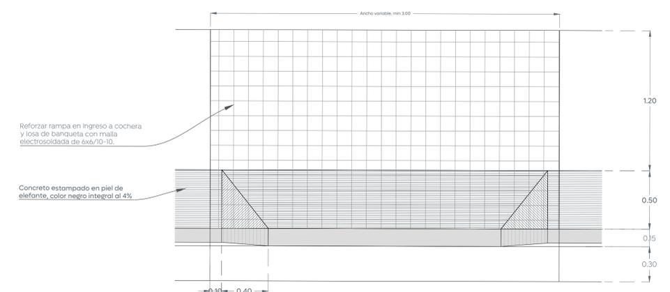
Detalle de rampa de cocheras Esc. 1:20
