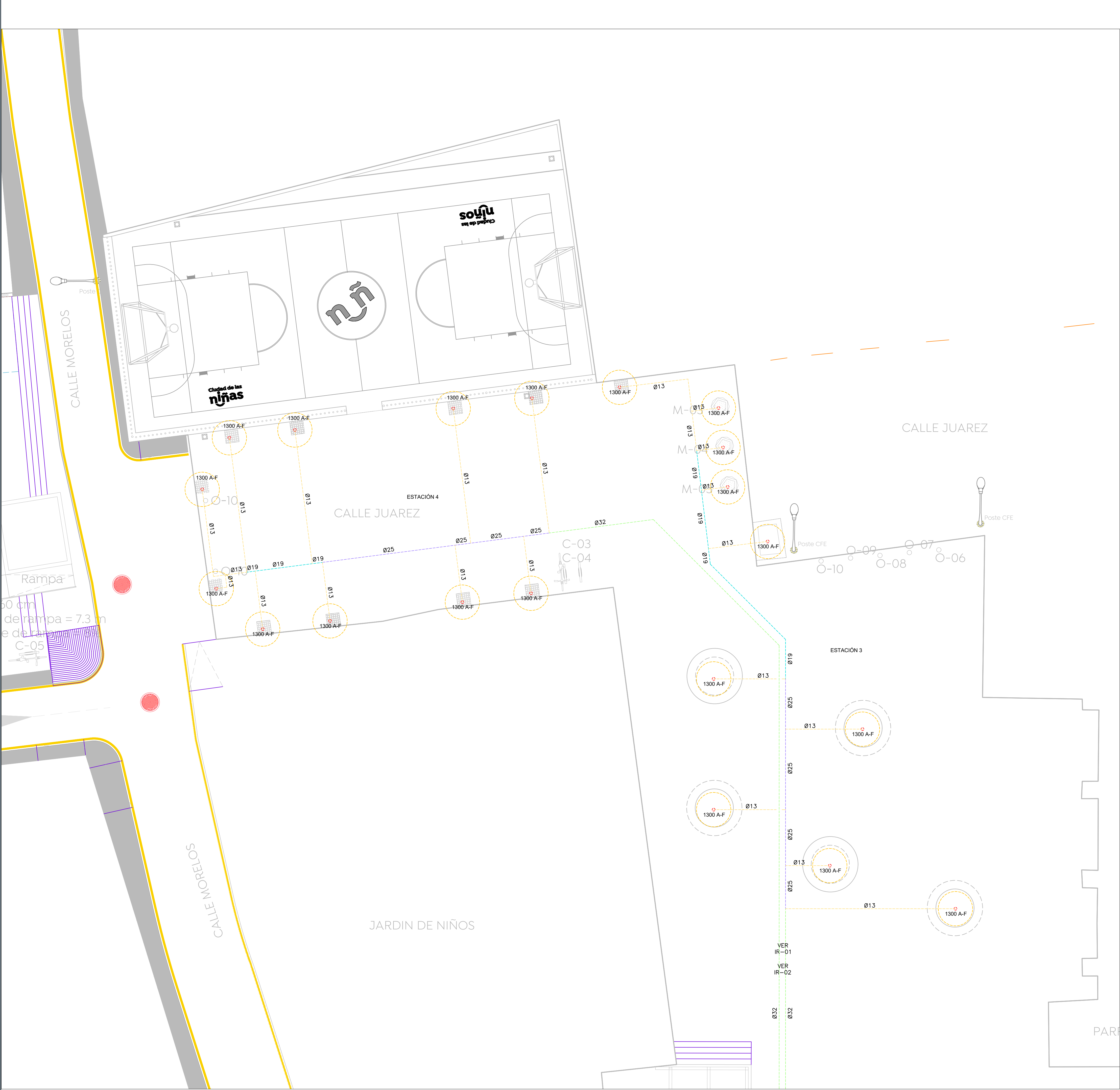
01 Planta 02 de Instalacion de Riego Aspersores 1:100
