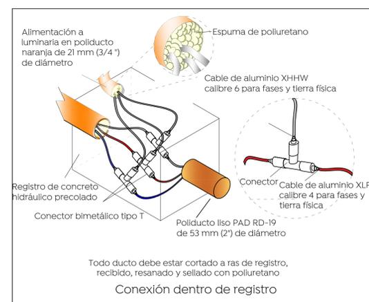
09 Conexión dentro de registro Escala S/E
