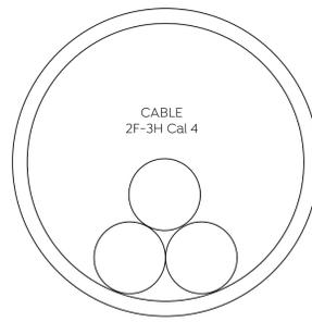
Diámetro de tubería: 51mm (2")
