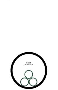
Diámetro de tubería: 51mm (2"Ø)
