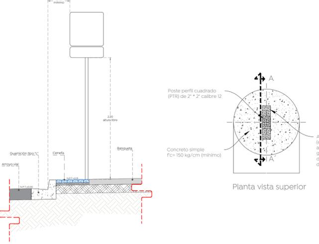
**2.2 Detalle de cimentación para señales** Escala S/E (m)
