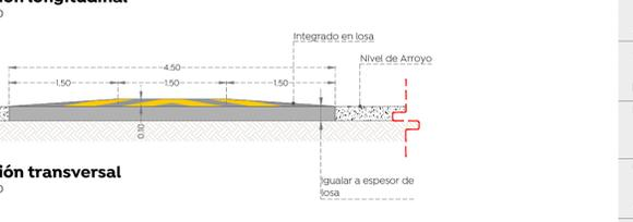
**2.2 Detalle reductor de velocidad** Escala 1:10
