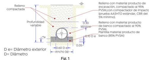
Fig. 1 Zanjas para tubería de agua potable.
