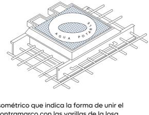
Isométrico que indica la forma de unir el contramarco con las varillas de la losa por medio de una varilla de 9.5 mm 3/8" Ø soldada perimetralmente al contramarco.
