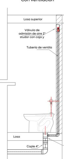
Detalle descarga de lavabo con ventilación
