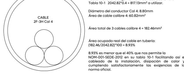
Diámetro de tubería: 51mm (2"Ø)
