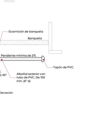
03 Detalle de llegada y salida de tubería
