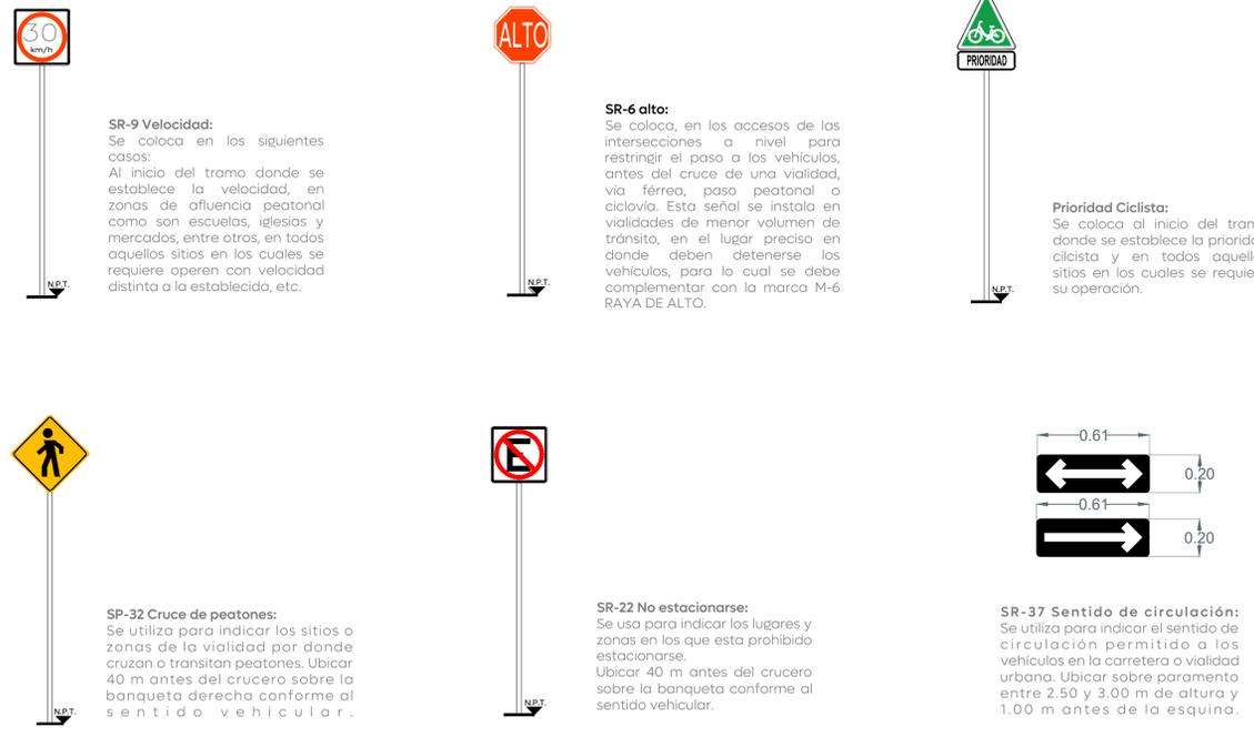
02 Detalles de señales verticales Escala 1:40
