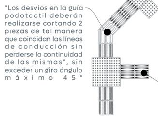
"Los desvíos en la guía podotáctil deberán realizarse cortando 2 piezas de tal manera que coincidan las líneas de conducción sin perderse la continuidad de las mismas", sin exceder un giro ángulo máximo 45°
