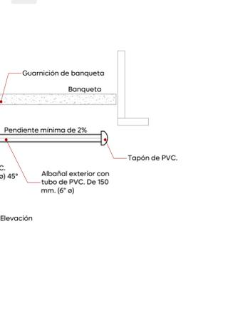
03 Detalle de llegada y salida de tubería
