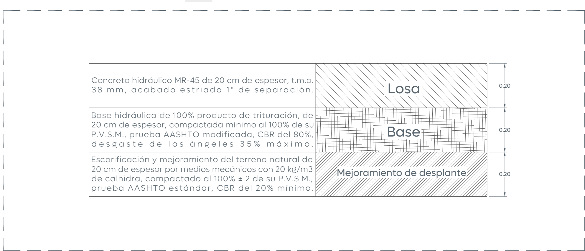
06 Conformación de pavimento Escala 1:10
