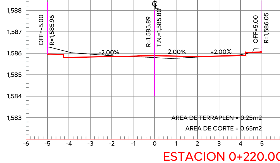
ESTACION 0+220.00 ESCALA HORIZONTAL 1:100 ESCALA VERTICAL 1:100
