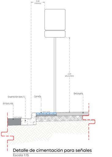
Detalle de cimentación para señales Escala 1:15
