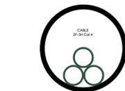
Diámetro de tubería: 51mm (2"Ø)
