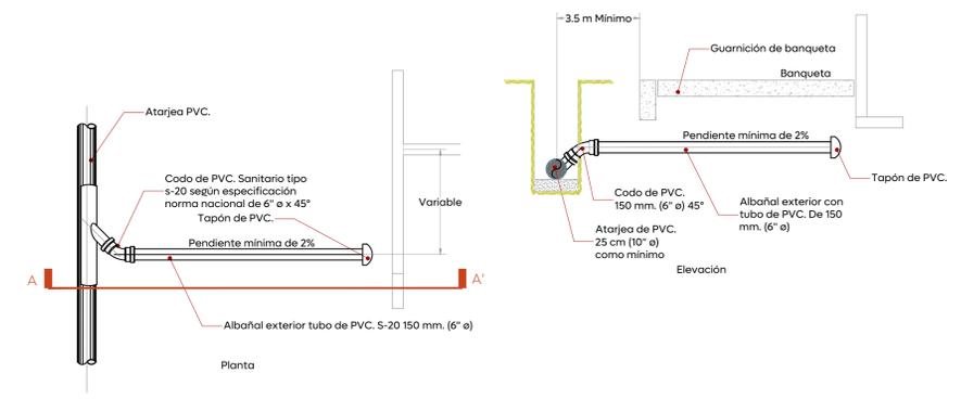
07 Detalle conexión de la descarga P.V.C
