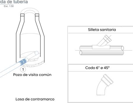
**03 Detalle de llegada y salida de tubería**
