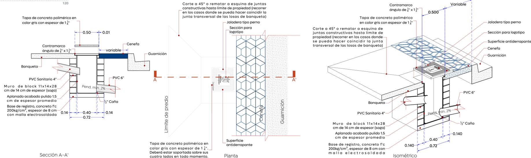
03 Detalle de modulación de losas
