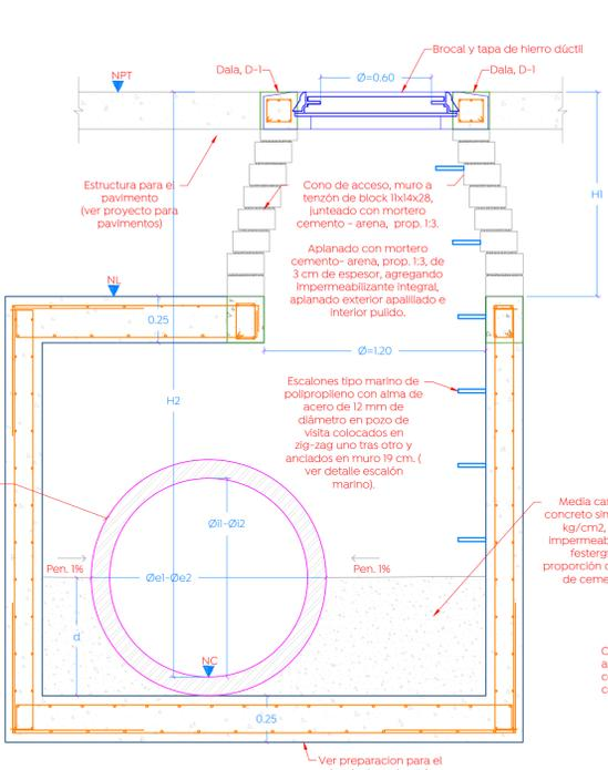
**Planta de losa de cimentación, caja pluvial**
