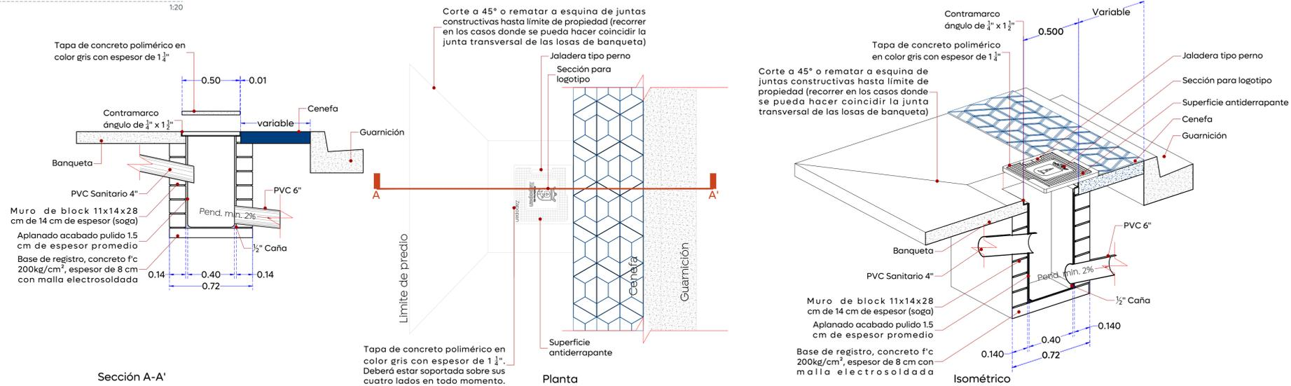
04 Detalle de modulación de losas 1:20
