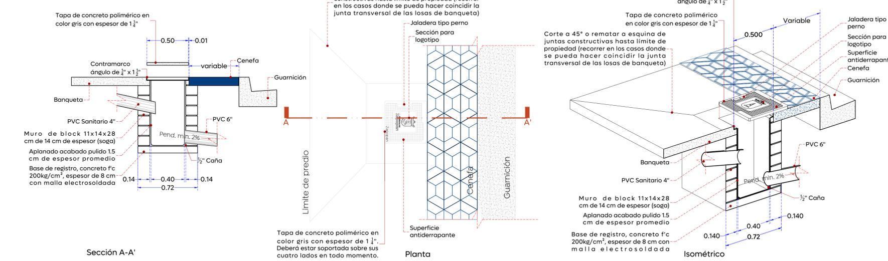
**03 Detalle de modulación de losas**
