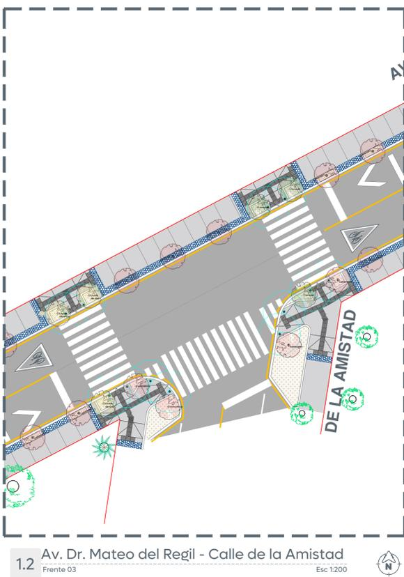
**ESPECIFICACIÓN:** Loseta vibro-prensada prefabricada con textura táctil puntual ó lineal en formato 40 cm x 40 cm x 4 cm de espesor, de uso peatonal, con resistencia a la compresión  $f_c=250$  kg/cm<sup>2</sup>.
