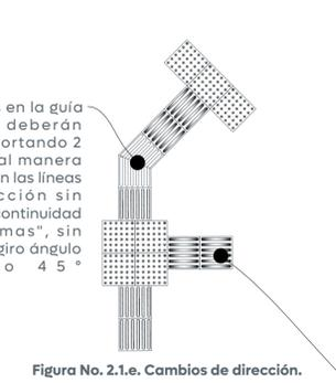
“Los desvíos en la guía podotáctil deberán realizarse cortando 2 piezas de tal manera que coincidan las líneas de conducción sin perderse la continuidad de las mismas”, sin exceder un giro ángulo máximo 45°
