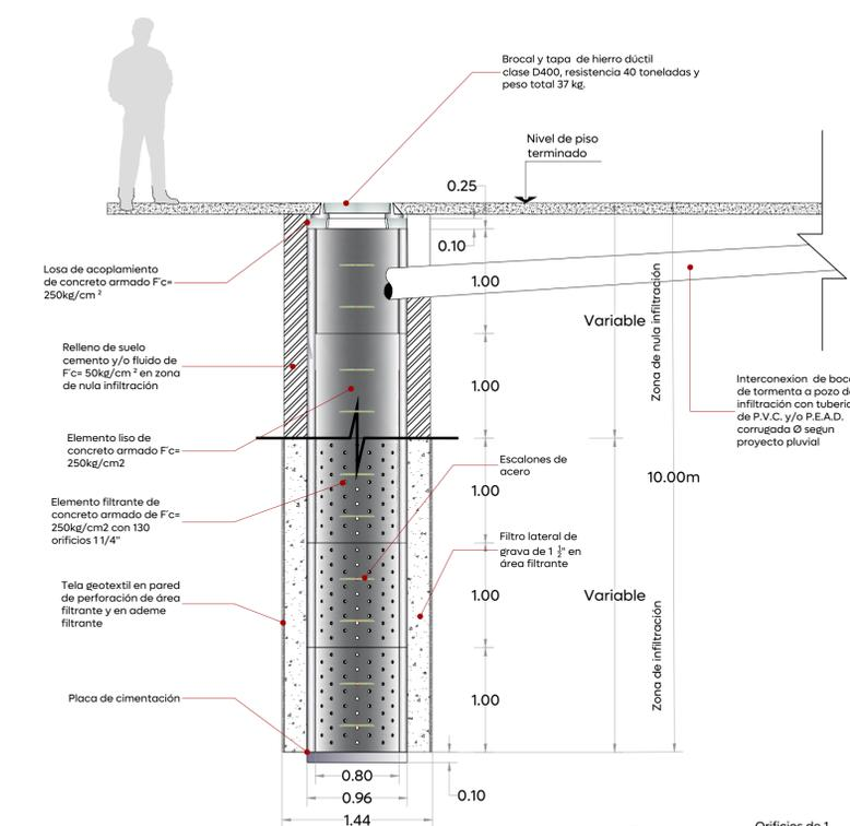
03 Detalle pozo de infiltración
