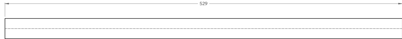
02 Columna 01 OC 10.750" x 0.307" CÉDULA 30 cotas: cm Esc. 1:25
