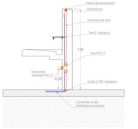
05 Sección A - A" - Hidráulico
