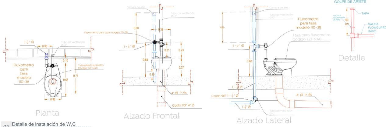
01 Detalle de instalación de W.C.
