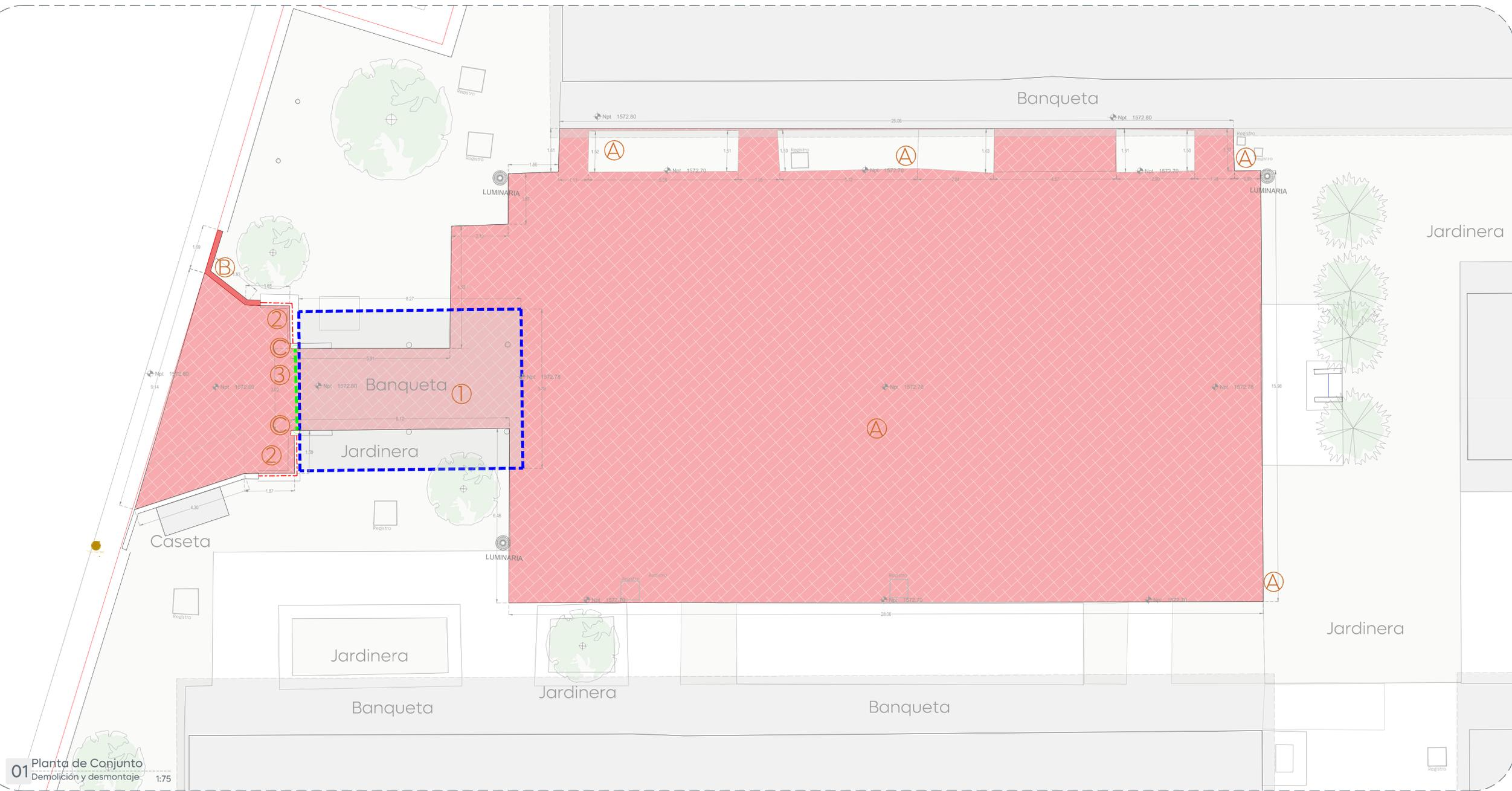
01 Planta de Conjunto Demolición y desmontaje 1:75
