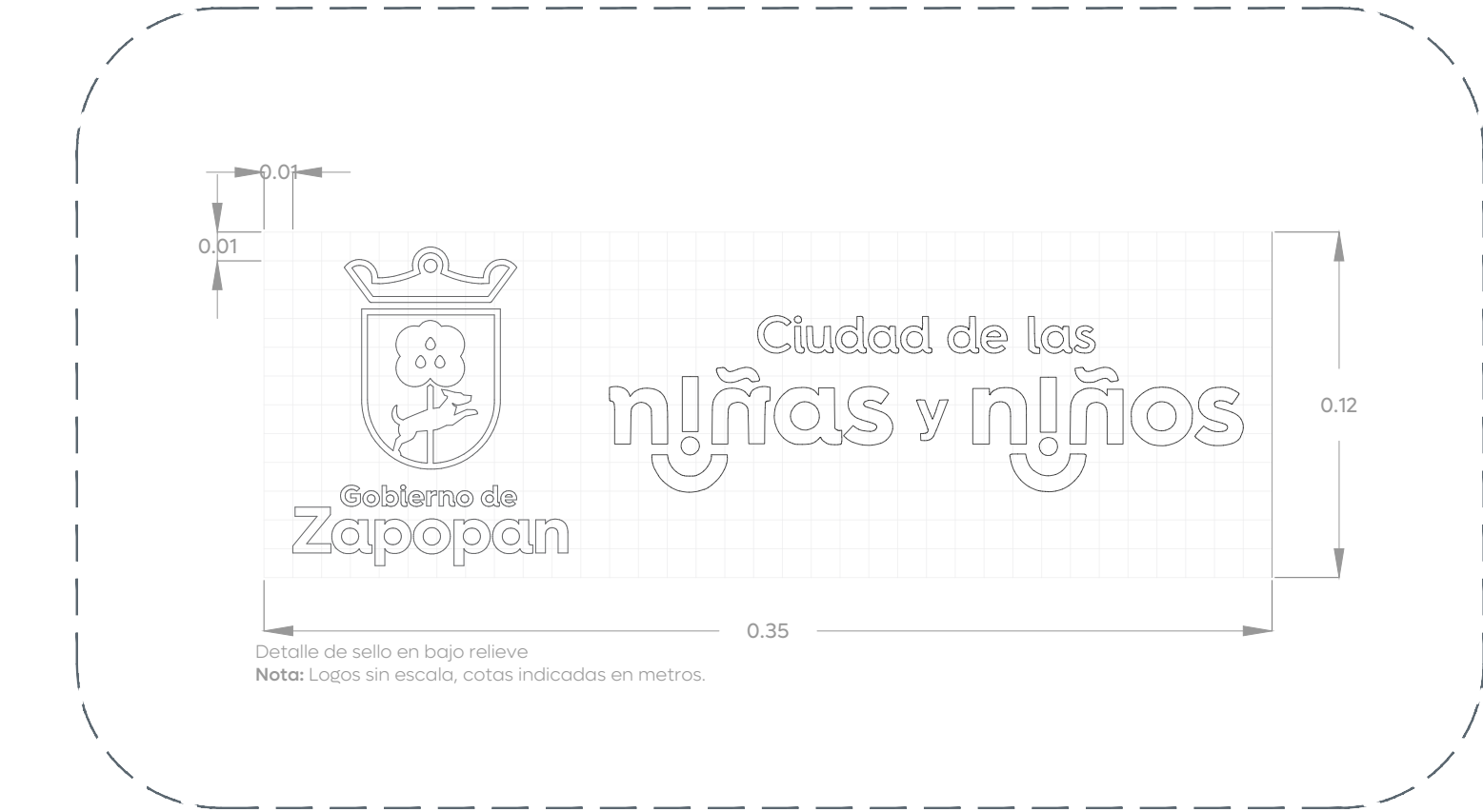
04 Sello de banqueteta Acabados en piso S/E
