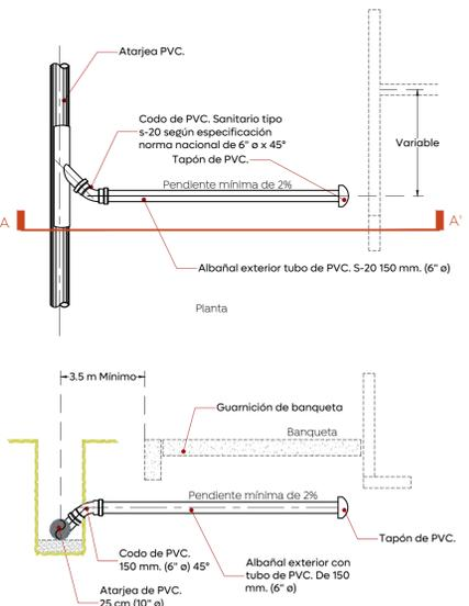
07 Detalle conexión de la descarga P.V.C. DRE.01 Escala S/E (m)
